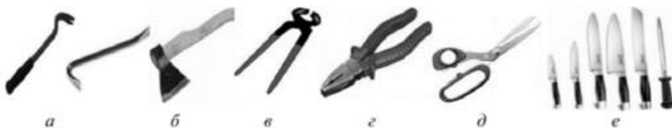
Рис. 6.2. Инвентарь для вскрытия тары и упаковки: а — гвоздодеры; б — топор; в - клещи; г - плоскогубцы; д - ножницы; е – ножи
